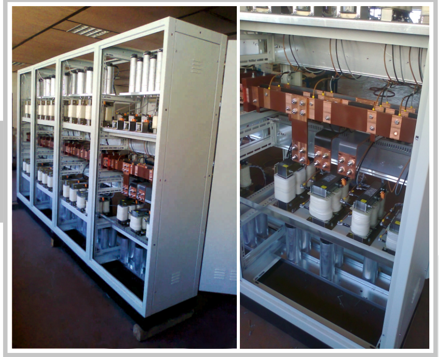
ANPA-K SERİSİ KOMPANZASYON PANOSU (HARMONİK FİLTRELİ REAKTÖRLÜ)
